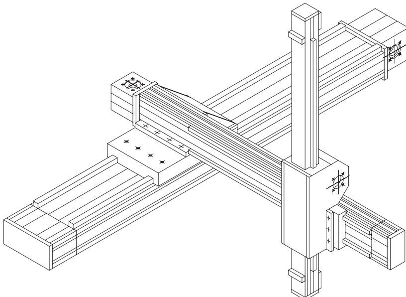
Système à trois axes X-Y-Z
