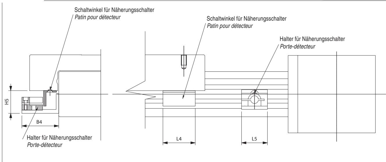
**Achtung:** Bei Verwendung von Faltenbälgen können die oben aufgeführten Zubehörteile für Näherungsschalter nicht verwendet werden.
