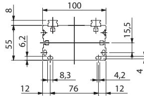
**ROBOT 100 SP-2C - Mit Kugelumlauf-Linearführung**
