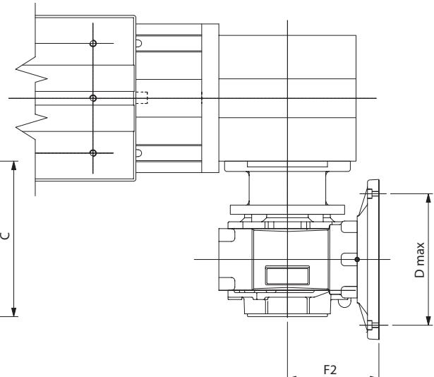
Montage des Schneckengetriebes auf beiden Seiten der Linear-Einheit möglich.
