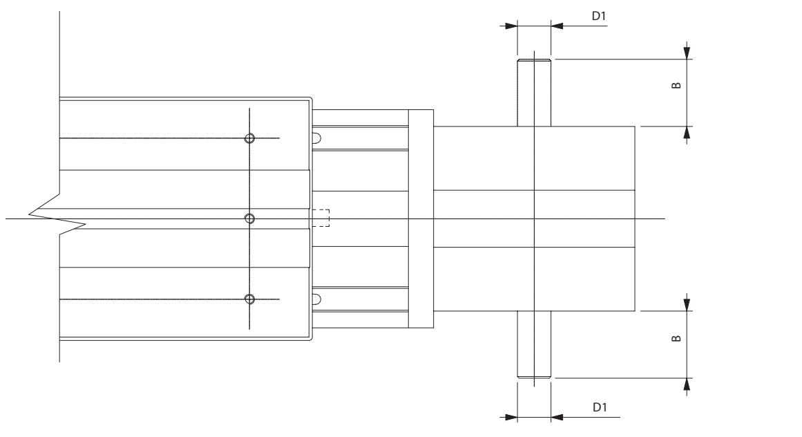
Der Zapfen kann auf beiden Seiten der Linear-Einheit vorgesehen werden
