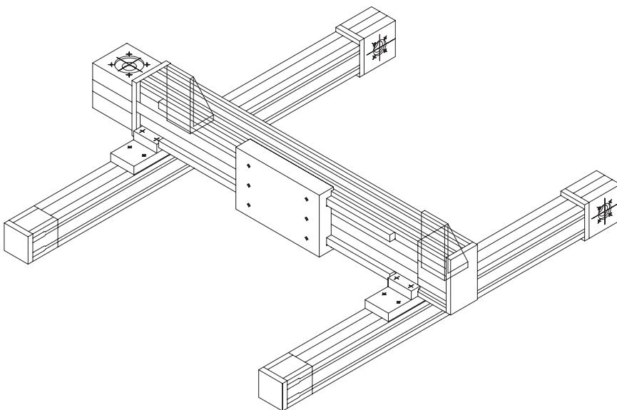
Auparavant, les fabricants de machines devaient concevoir et réaliser tous les éléments nécessaires au montage de deux ou plusieurs axes. Pour répondre aux besoins du client, EL.MORE a étudié une série d'accessoires, qui permettent de fabriquer facilement et rapidement des systèmes multi-axes. EL.MORE offre au client un assortiment d'accessoires telles que équerres, brides et plaques en croix, partiellement déjà intégrées directement dans l'unité linéaire.
