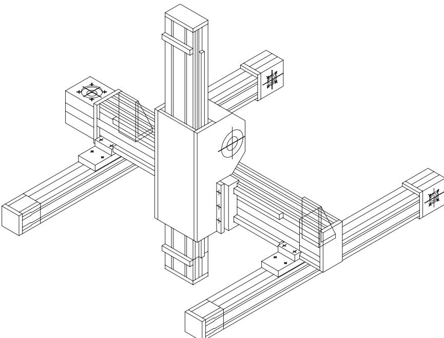
Système à trois axes X-Y-Z
