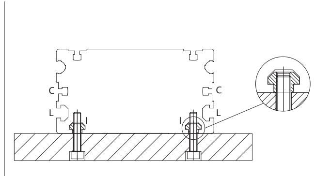
**Nutenstein** T-Nutenstein aus Stahl zur Verwendung in den Nuten am Profil
