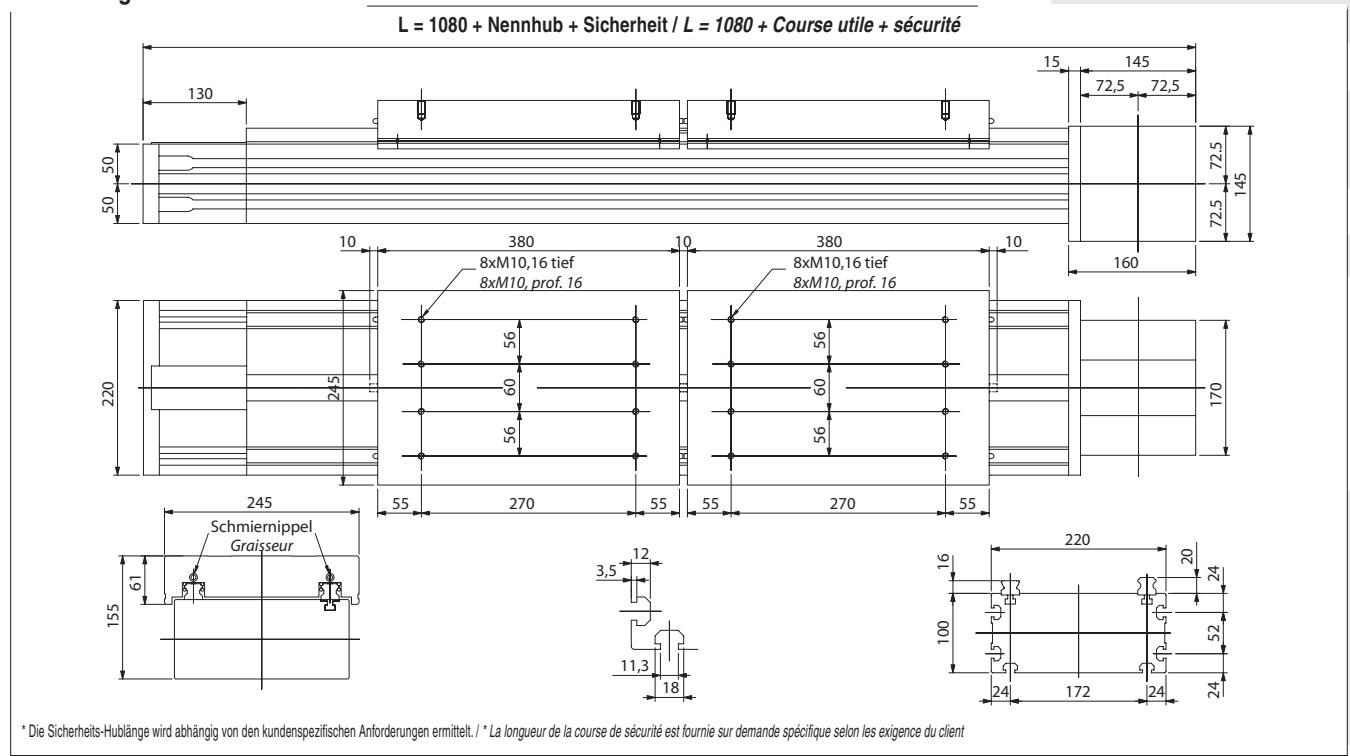
Die Linear-Einheiten EL.MORE der Serie ROBOT können mit verschiedenen Versionen von Antrieben ausgestattet werden. Bei allen Versionen wird das Antriebsmoment auf die Zahnriemenscheibe mittels Schrumpfscheibe übertragen. Dieses System garantiert einen spielfreien Antrieb während des gesamten Betriebes.
