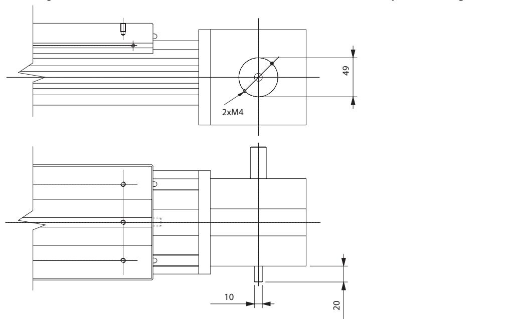
Der Zapfen kann auf beiden Seiten der Linear-Einheit vorgesehen werden
