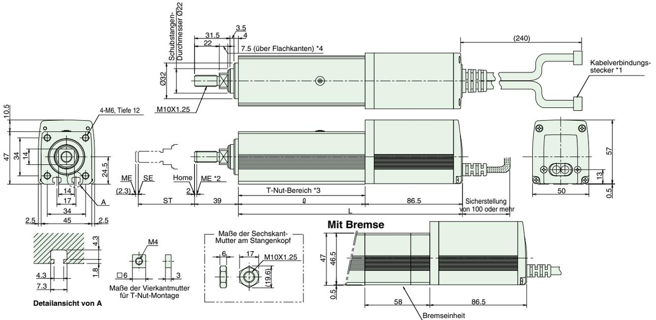
\* Modelle mit Bremse haben eine erweiterte Gesamtlänge um 58 mm und ein um 0,4 kg erhöhtes Gewicht.
