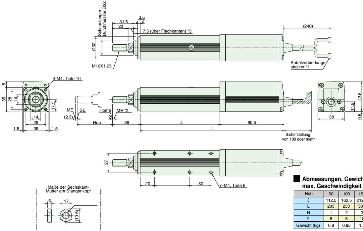
Abmessungen, Gewicht und max. Geschwindigkeit pro Hub
